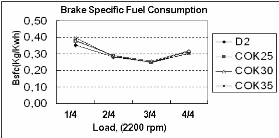
Figure 3.The variation of the bsfc for different blended fuels under fixed to 2200 rpm engine speed and various throttle opening position. (Şekil.3 Değişik gaz kelebeği konumlarında, 2200 d/d sabit motor devrinde özgül yakıt tüketiminin karışımlara göre değişimi)
