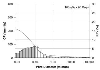
Figure 2. Pore size distribution of paste M2 (Şekil 2. Referans hamur M2 için boşluk oranı dağılımı)
