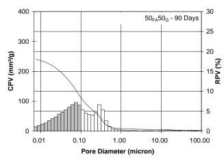
Figure 4. Pore size distribution of paste M4 (Şekil 4. Referans hamur M4 için boşluk oranı dağılımı)
