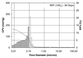
Figure 1. Pore size distribution of the reference paste M1 (Şekil 1. Referans hamur M1 için boşluk oranı dağılımı)
