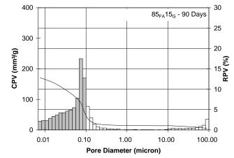
Figure 3. Pore size distribution of paste M3 (Şekil 3. Referans hamur M3 için boşluk oranı dağılımı)
