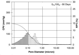
Figure 5. Pore size distribution of paste M5 (Şekil 5. Referans hamur M5 için boşluk oranı dağılımı)
