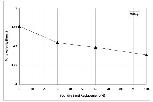
Figure 5. Ultrasonic pulse velocity (UPV) of concretes containing varying amounts of foundry sand at 28 days of curing (Şekil 5. Değişik oranlarda dökümhane kumundan üretilen betonların 28
