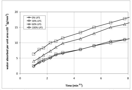
Figure 2. Capillary water absorption of concretes containing varying amounts of foundry sand at 28 days of curing - First 1 hour of absorption (Şekil 2. Değişik oranlarda dökümhane kumundan üretilen betonların 28 günlük kürde elde edilen ilk 1 saat için kapiler su emme değerleri)
