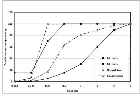
Figure 1. Particle size distribution of normal sand and foundry sand (Şekil 1. Normal ve dökümhane kumunun elek analizi değerleri)
