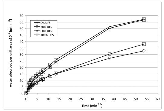
Figure 3. Capillary water absorption of concretes containing varying amounts of foundry sand at 28 days of curing - First 48 hours(Şekil 3. Değişik oranlarda dökümhane kumundan üretilen betonların 28 günlük kürde elde edilen ilk 48 saat için kapiler su emme değerleri) e-Journal of New World Sciences Academy Engineering Sciences, 1A0230, 6, (4), 1224-1230. Khatib, J.M., Herki, B.A., Fırat, S., Menadi, B. and Kenai, S.
