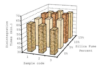
Graph 2. Disintegration times of the samples under the effect of water (Grafik 2. Su Etkisi altıdaki kerpiç numunelerin dağılma zamanları)
