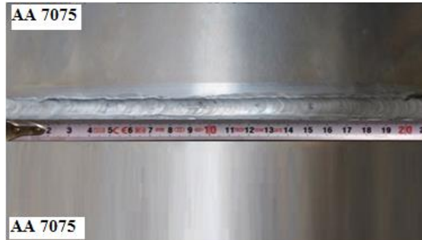
Şekil 2. AA7075 kaynaklı birleştirmesi (Figure 2. Welded sample of AA7075)
