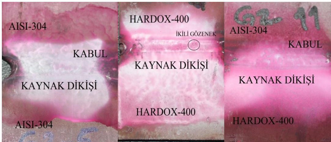
AISI304-AISI304 HARDOX400-HARDOX400 AISI304-HARDOX400 Şekil 8. Numunelerin sıvı penetrant test resimleri (Figure 8. Liquid penetrant testing test pictures of samples)
