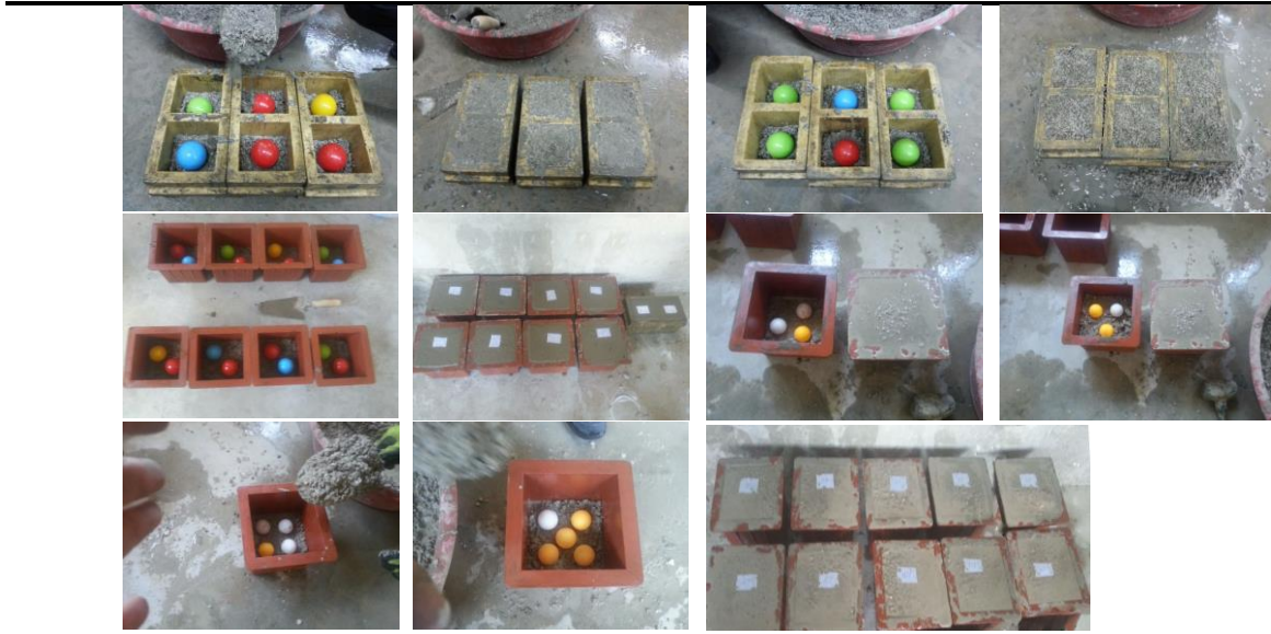
Resim 2. Taze betonun içine topların yerleştirilmesi (Figure 2. The placing balls into fresh concrete)
