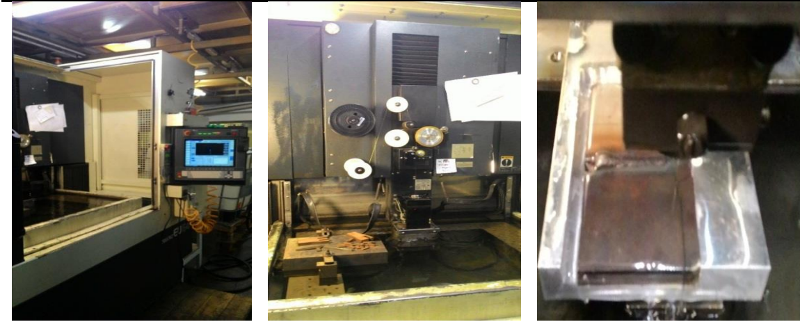
Şekil 22. Tel erezyon tezgahı ve kesim esnasındaki çelik çiftlerinin görünümü
