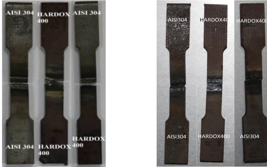
Isıl İşlem Uygulanmayan Numuneler Isıl İşlem Uygulanan Numuneler Şekil 55. Kaynaklı birleştirmelerin çekme testi sonrası görüntüleri
