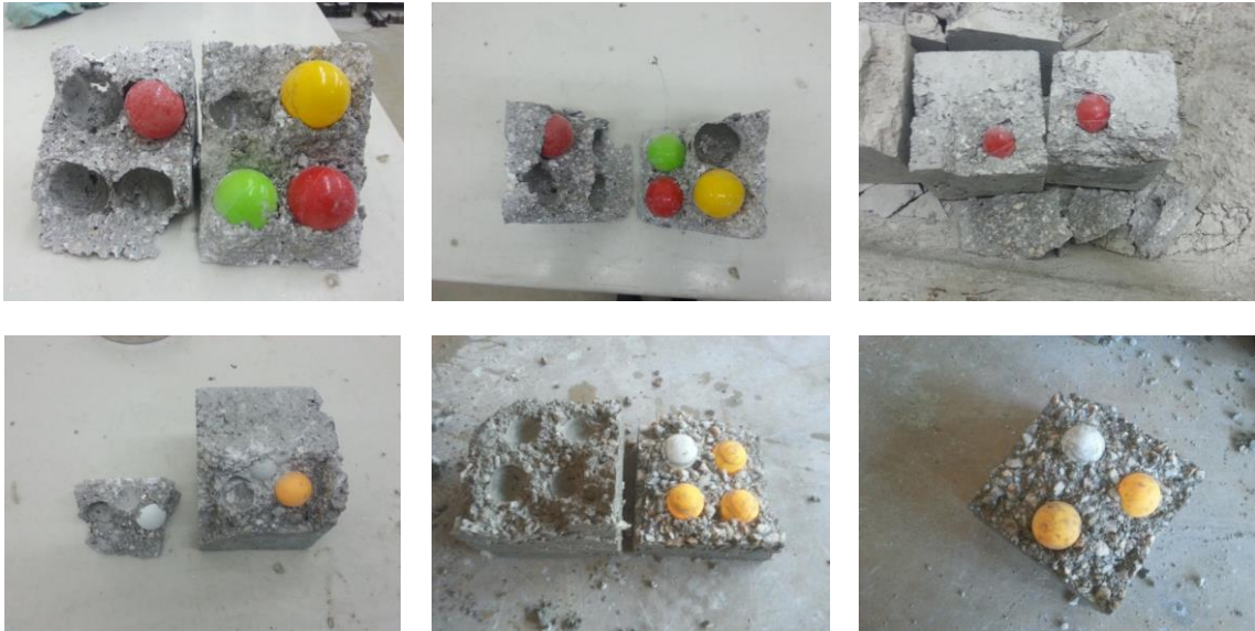
Resim 3. Basınç dayanım deneyi sonrası betonların genel görünümü (Photo 3. General overview of the concretes after compressive strength test)
