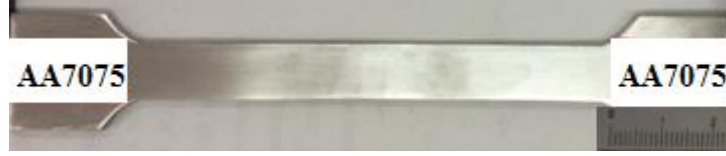
Şekil 3. Çekme deney numunesi (Figure 3. Tensile test sample)
