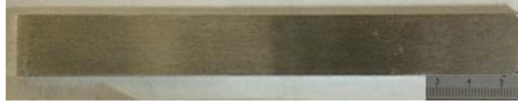
Şekil 4. Eğme deney numunesi (Figure 4. Bending test sample)
