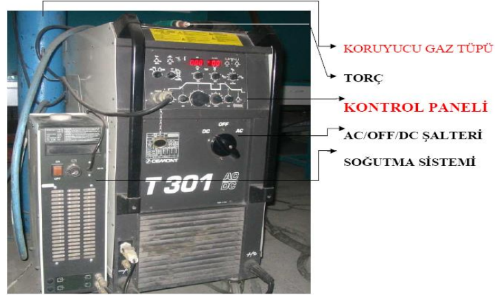
Şekil 1. GTA kaynak donanım resmi (Figure 2. Figure of GTA welding equipment)
