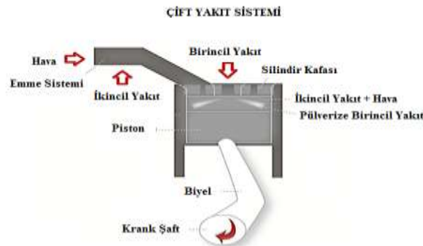
Şekil 1. Çift yakıt sistemi şematik görünüşü (Figure 1. Schematic diagram of dual-fuel system)
