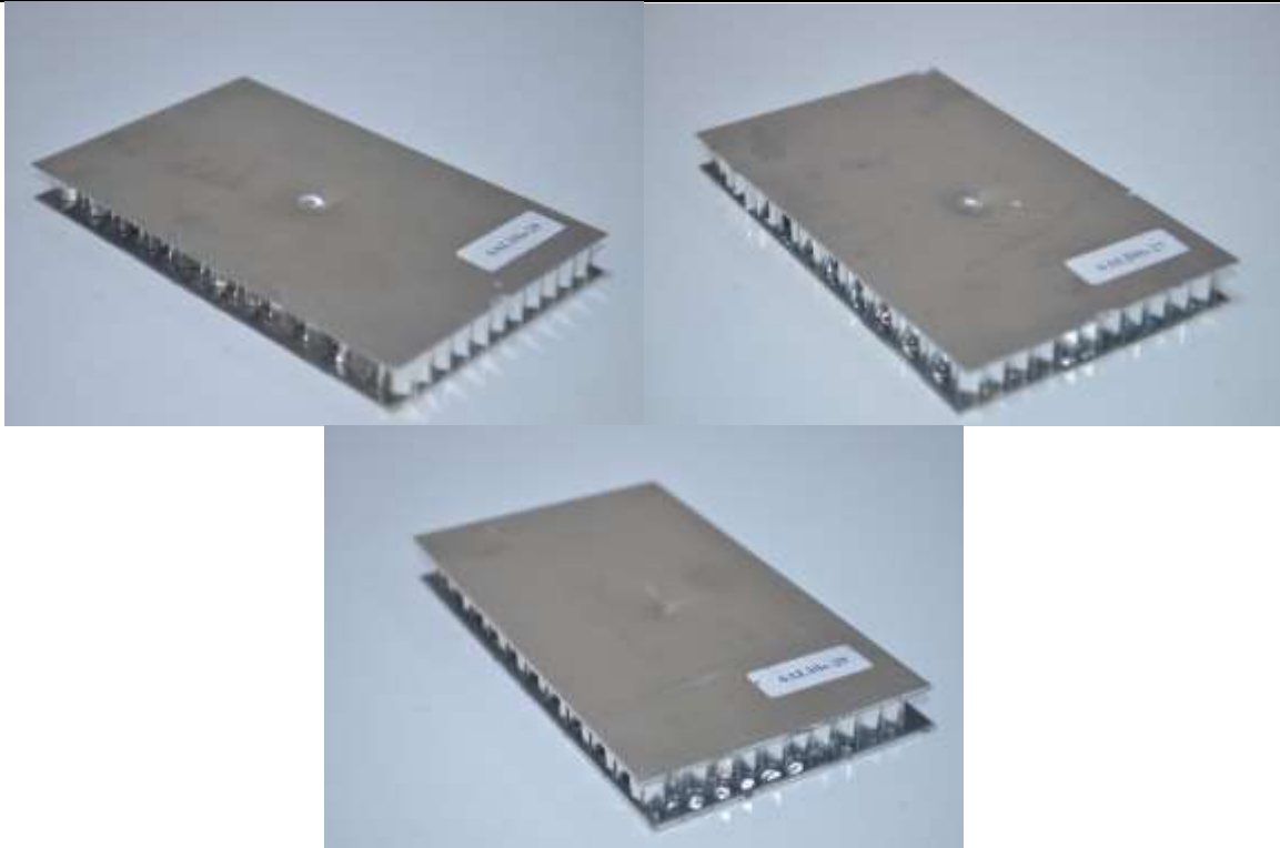
Şekil 5. 5 J darbe enerjisi için farklı yüzey malzemesi kalınlıklarına sahip numunelerin darbe testi sonrası görüntüleri (a. H=0.5 mm, b. H=1 mm, c. H=1.5 mm)
