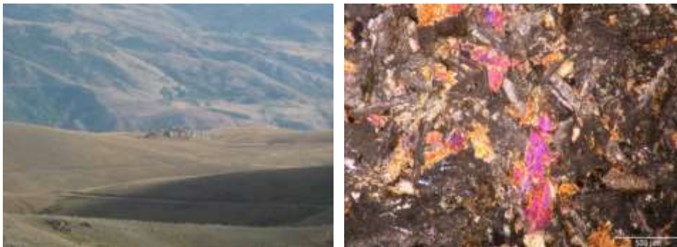
Şekil 7. Kop dağlarında yüzeyleyen diyabaz mostrası (solda) ile bu diyabazın polarizan mikroskopta çift nikol görüntüsü (sağda) (Figure 7. Double neck image of the diabase on a polarizing microscope with the diabase outbreak on the Kop mountains (on the right))
