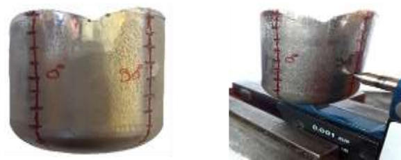
Şekil 2. İş parçası et kalınlığı ölçümü (Figure 2. Workpiece meat thickness measurement)
