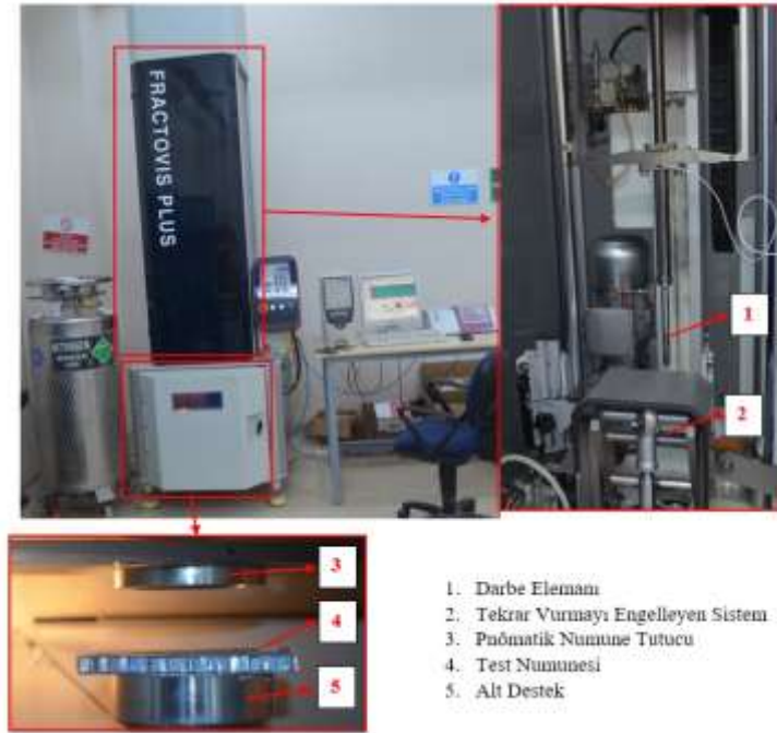
Şekil 2. Darbe testleri gerçekleştirilirken kullanılan CEAST-Fractovis Plus darbe test cihazı
