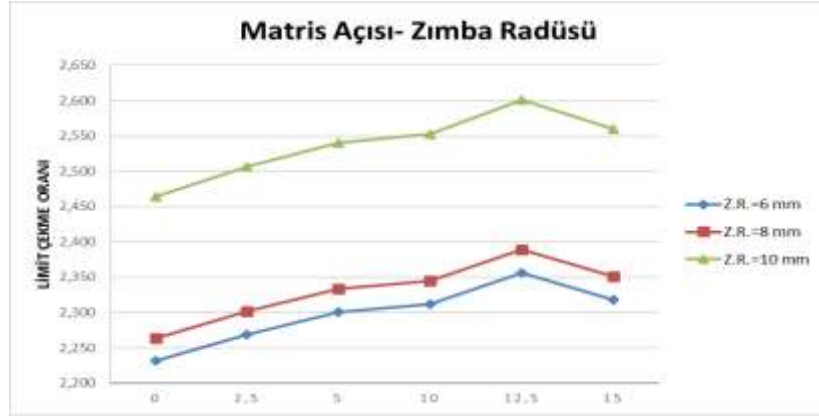
Şekil 3. Matris/Baskı Plaka açılışının limit çekme oranına etkisi (Figure 3. Effect of opening of matrix/printing plate to limit pull ratio)
