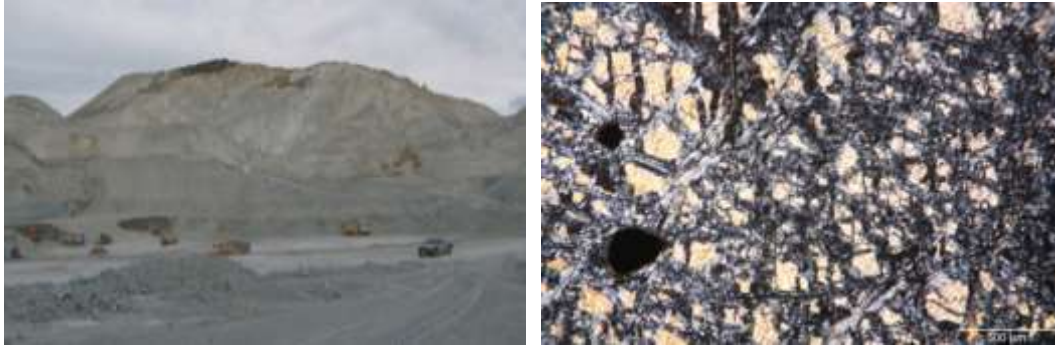
Şekil 5. Batı Kop dağlarında geniş dünit zonu içindeki kromit cevheri açık işletmesi (solda) ve polarizan mikroskop altında Çift nikolde serpantinleşmiş dünit görüntüleri (sağda) (görüntü 2400 kez büyütülmüştür)
