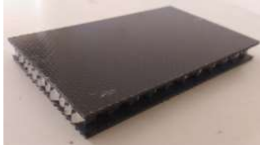
Şekil 1. Karbon fiber takviyeli kompozit yüzey malzemesine sahip numune (Figure 1. Sample with carbon fiber reinforced face sheet)
